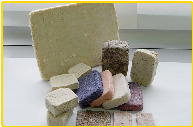
Fig. 2. Compositi di fibra di canapa e lana di scarto
