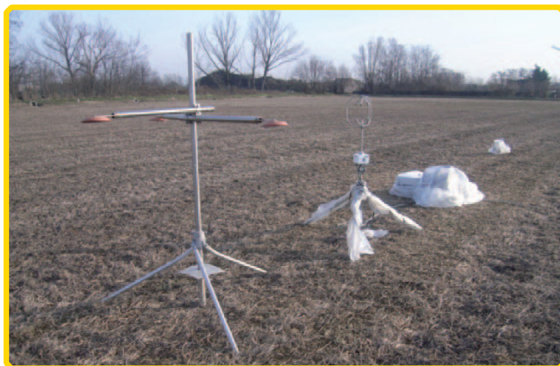
Fig. 1. La strumentazione per le misurazioni di flussi di ammoniaca e protossido di azoto.
